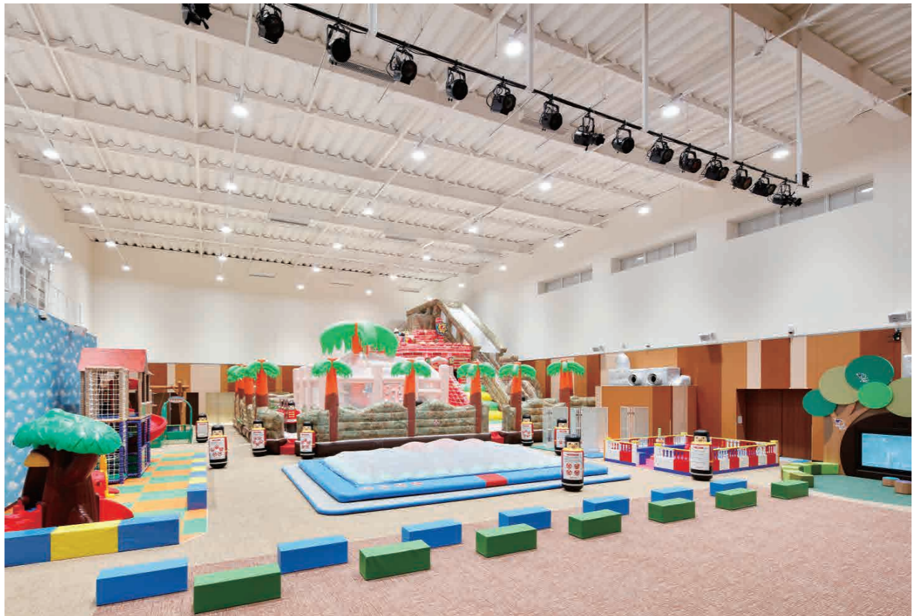
一番奥に見えるのが全長9m、高低差6mと迫力満点の巨大スライダー。スライダーも含め遊具は厚く気密性の高い布地で縫製され、常時空気を送り込み形状を維持しているため、上に乗って元気に飛び跳ねることができる。天井までの高さは10m。LED照明の交換は、スライダーの上に特注の台を載せて行う。そのアイデアも創和アーキテクトを主体とした建設チームで提案した
